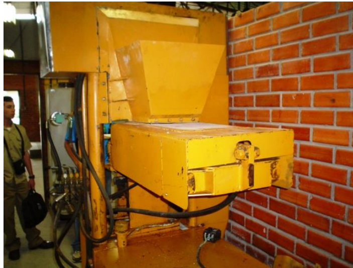
Figura 6 - Detalhes da Máquina - Silo de Alimentação
