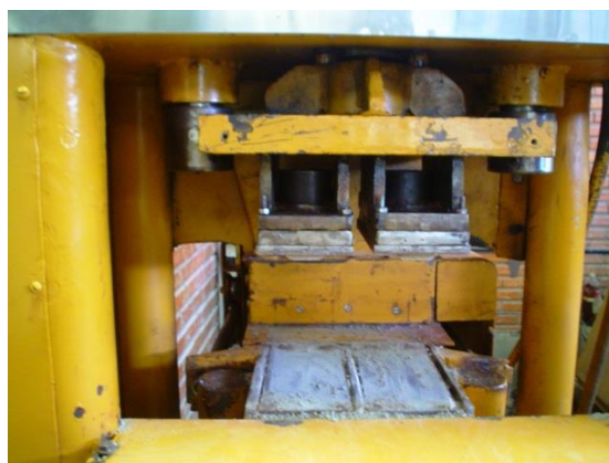
Figura 5 - Detalhes da Máquina – Retirada Manual dos Tijolos
